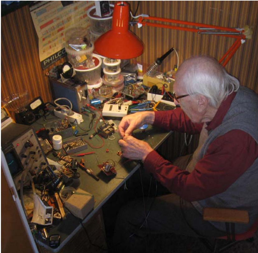
Pappa Sture Sundgren (87 assisterar vid avstämning av ferritantenn för 77,5 kHz..
